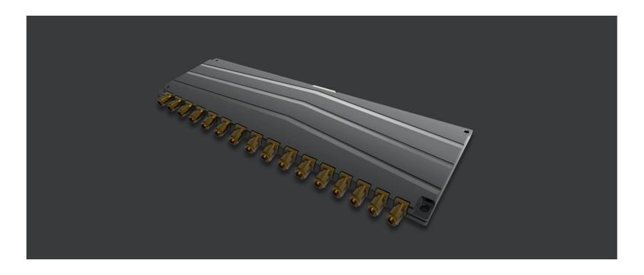
为了进一步提高模块的集成效率,增加了单个模块的应用产出,我们设计研发了十六端口的高性能 RFID 模块。该模块在天线应用的接口上面达到了一个更高的层次,提供有高达十六个 SMA 天线接口。在实际应用过程中集成该模块可实现更密集、更广的信号覆盖,让标签能够更快速、更灵敏的被读取。同时该模块每个天线最短可实现 25ms 轮询时间,模块能够根据标签实际分布自动分配端口驻留时间,让模块单个端口读取速度也达到最优。
