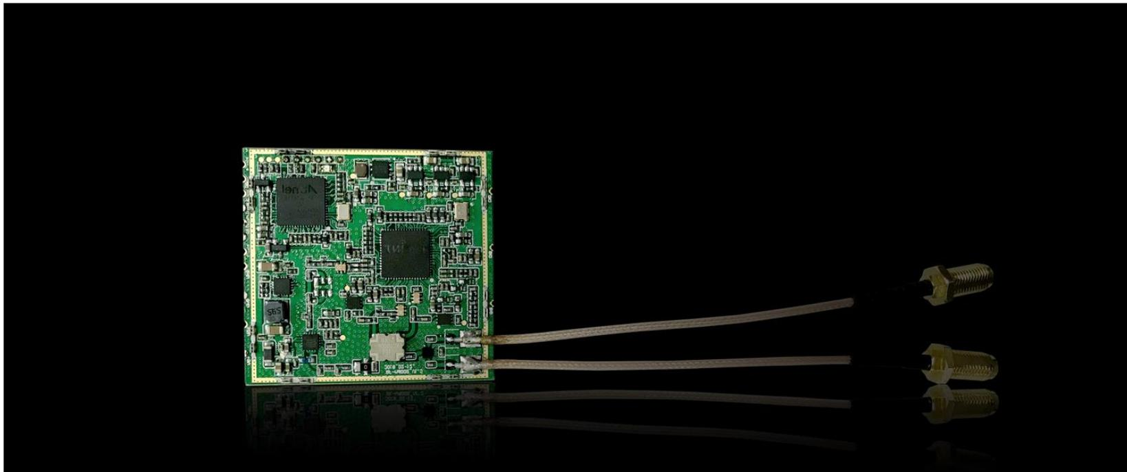
RF-M6002 是国芯物联自主研发的一款高性能双通道嵌入式超高频 RFID 读写模块，该模块主要是解决单通道读写模块的空间盲点问题，弥补单通道读写模块在应用中的读取不足。同样可直接嵌入标签打印机、RFID 手持终端、平板 PDA 以及固定式或移动式读写器终端。具有读取面积大、灵敏性强、性能稳定等特点，同时还拥有优越的抗电磁干扰能力和散热性能，完全可以满足各类环境的使用需求，是 RFID 设备制造商首选的 RFID 读写器模块。
